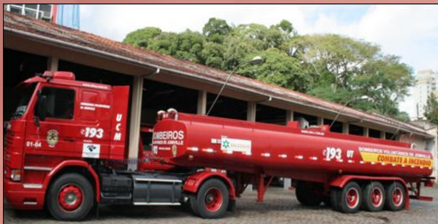
Veículos de Combate a Incêndio Tanque de 30.000 litros
