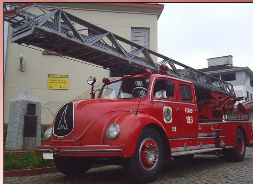
Escada Mecânica Alcance vertical - 32 metros Motor Magirus Ano de Fabricação 1957 - 55 anos.
